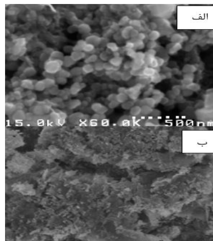
شکل ۱: تصویر SEM، الف: نانو ذره Fe_3O_4 و ب: بنتونیت - Fe_3O_4
