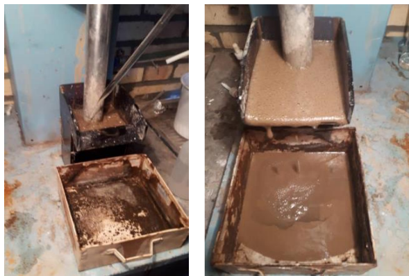
شکل ۲: نحوه انجام آزمایش‌های فلوتاسیون
