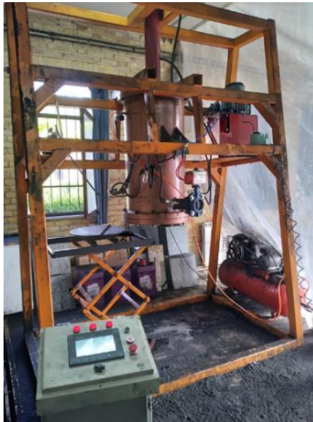
شکل ۲: شمای کلی دستگاه بررسی تصاعد آبی گاز زغال و گاز کشی در معادن زغال سنگ
