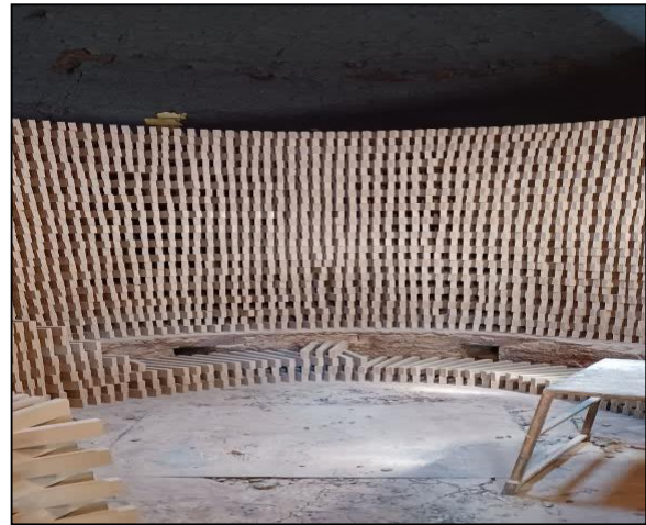
شکل ۴: نمای داخلی و نحوه چینش آجرها داخل کوره آجرپزی
