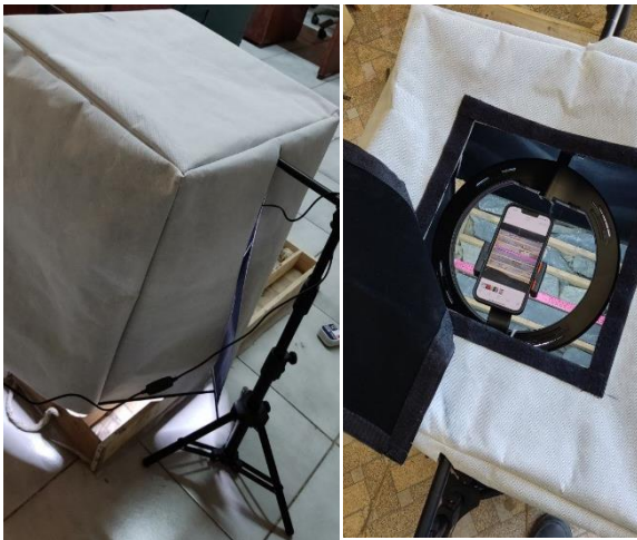
شکل ۳: نمای دستگاه استفاده شده برای عکس‌برداری از جعبه مغزه‌ها
