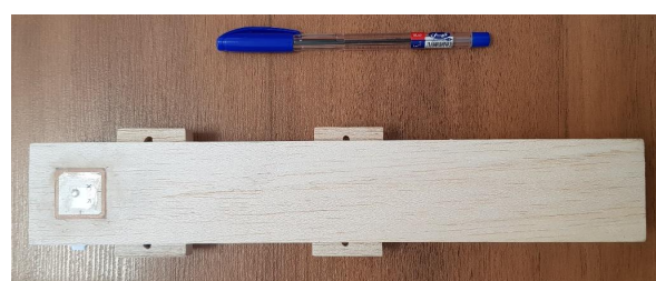
شکل ۳: نمایی از حسگر (که در داخل جعبه‌ای از جنس چوب بالسا تعبیه شده است).
