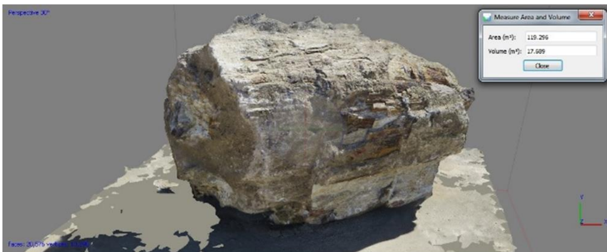
شکل ۶: محاسبه حجم یک بولدر تولیدی مربوط به بلوک انفجاری ۱۴۲-۱۳ در محیط نرم‌افزار Agisoft Metashape
