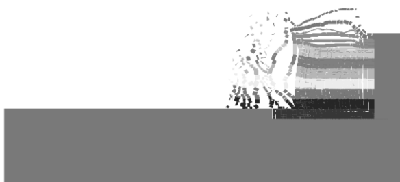
شکل ۱۴: مدل‌سازی عددی حرکت توده خرد شده در اثر انفجار در زمان ۳۵ms پس از تکمیل بارگذاری دینامیکی انفجار با ضریب میرایی کوچکتر
