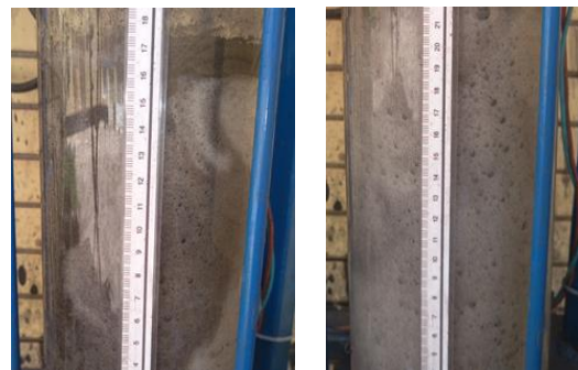
شکل ۸: رنگ کف در شرایط آزمایش با مقدار d_{50} و کف‌ساز بیشینه
