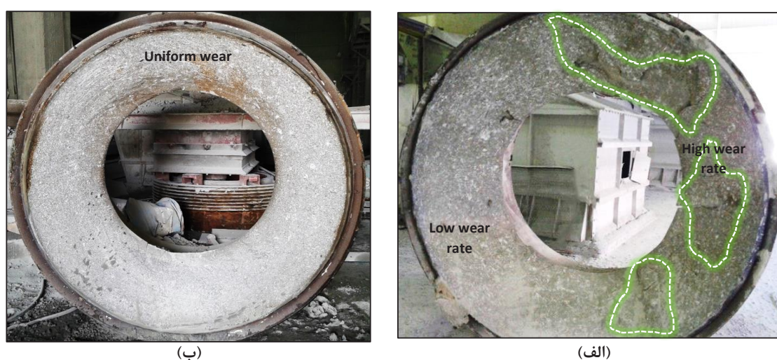
شکل ۱۵: مقایسه سایش آستر بدنه سنگ‌شکن: الف) قبل از نصب مجرای خوراک‌دهی جدید، ب) بعد از نصب
