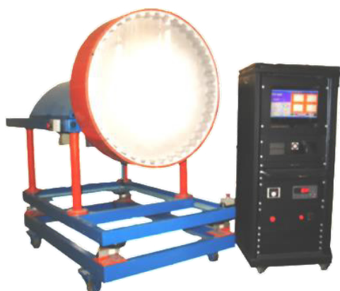
شکل ۲: آسیای آزمایشگاهی با قطر یک متر
