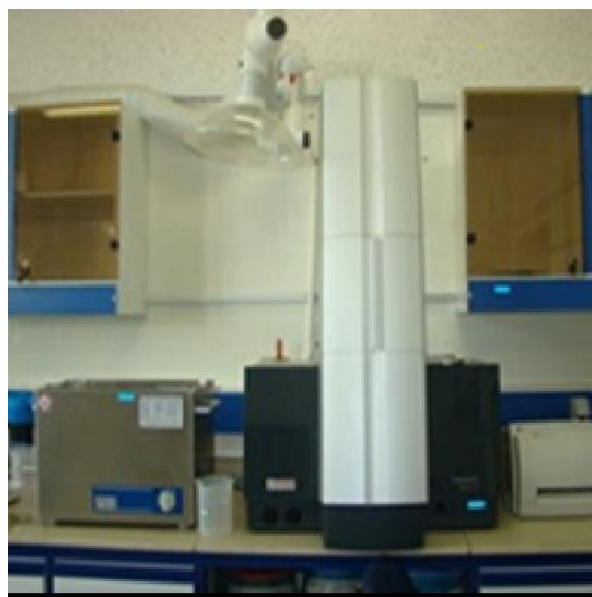
شکل ۳: دستگاه Laser Particle Sizer Analysette 22 برای دانه‌بندی ذرات ریزتر از ۶۳ میکرون [۱۶-۲۳]
