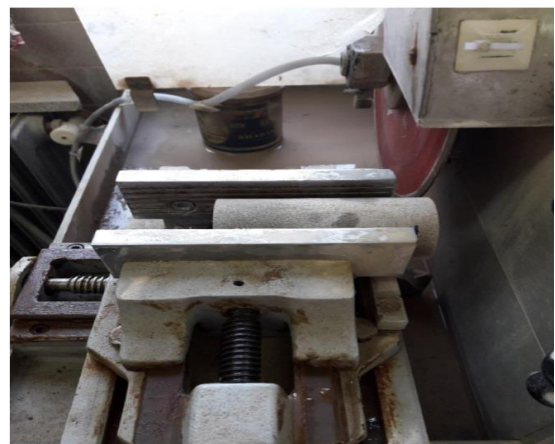
شکل ۶: دستگاه برش برای آماده‌سازی نمونه‌های بتن و ملات سیمان
