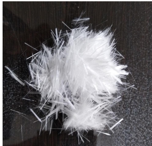
شکل ۴: الیاف شیشه مورد استفاده در پژوهش
