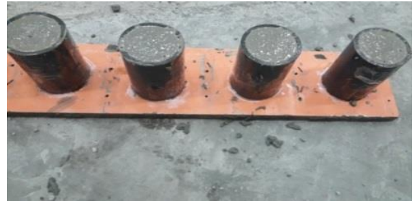
شکل ۵: لوله‌های PVC پر شده از بتن
