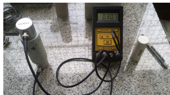
شکل ۷: نحوه قرارگیری ترانس دیوسرها روی نمونه
