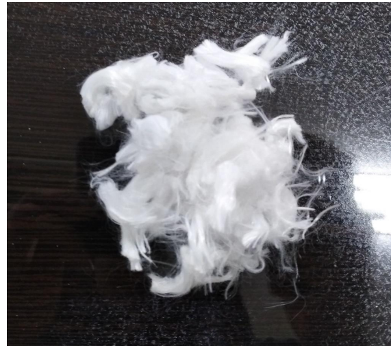
شکل ۳: الیاف پلی پروپیلن مورد استفاده در پژوهش
