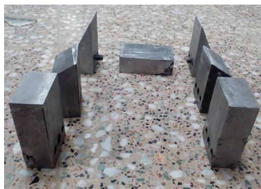
شکل ۵: قسمت‌های جدا شده برنده‌ها در قالب فولادی
