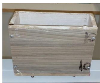
شکل ۳: ابعاد داخلی قالب ساخته شده برای تهیه نمونه‌های گچ
