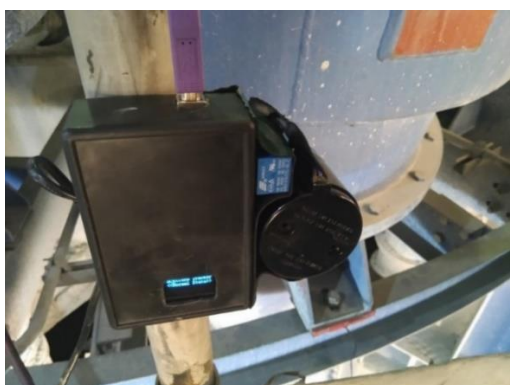
شکل ۱۳: حسگر ساخته شده بر مبنای پدیده پیزوالکتریک همراه برد و آژیر هشدار
