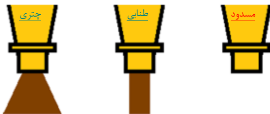
شکل ۲: حالت‌های هیدروسیکلون، نشان‌دهنده عملکرد طبیعی ("چتری") و عملکرد غیرعادی ("طنابی" و "مسدود") [۵]
