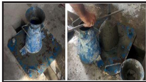
شکل ۱: آزمایش اسلایپ بتن
