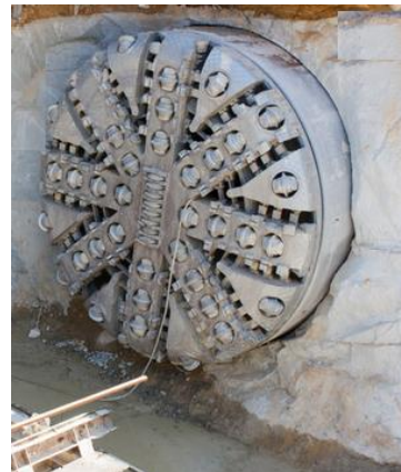
شکل ۱: ماشین حفاری سنگ سخت [۱]
