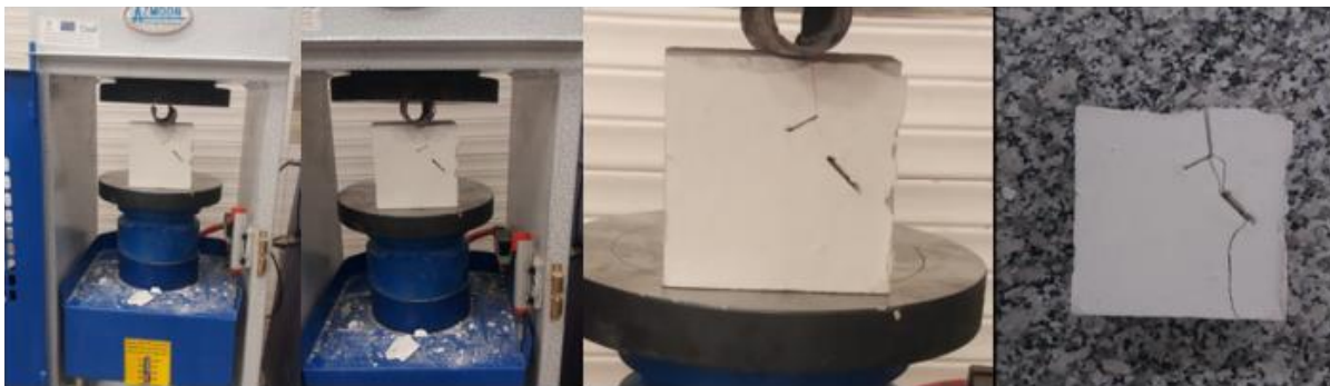
شکل ۵: الگوی شکست درزه ناممتد ۱سانتی‌متری با فاصله ۲سانتی‌متر تا برنده II شکل و زاویه ۴۵ درجه نسبت به افق و درزه ناممتد ۲سانتی‌متری با فاصله ۲سانتی‌متر عمود بر درزه ناممتد ۱سانتی‌متری
