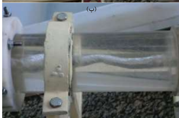
شکل ۸: هسته هوا در تری فلو (الف: مرحله اول، ب: مرحله دوم)
