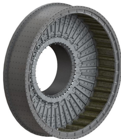
شکل ۱۶: مدل سه بعدی آسیا با آسترهای طرح جدید دیواره
