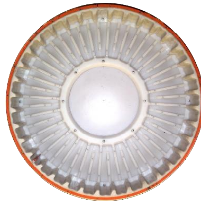
شکل ۵: آسترهای طرح جدید نصب شده در آسیا
