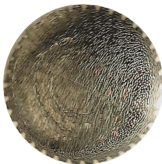
شکل ۷: نمایش حرکت بار در آسیای نیمه خودشکن خشک با آسترهای دیواره طرح اصلی ول آسیا (قرمز رنگ)
