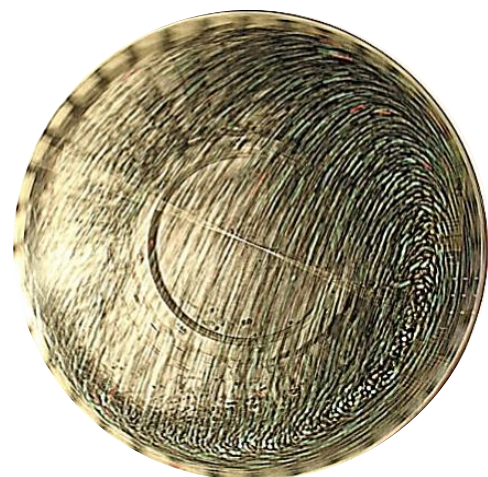
شکل ۱۸: نمایشی از حرکت بار درون این آسیا با آسترهای دیواره طرح جدید
