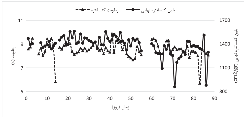
شکل ۲: رابطه رطوبت و عدد بلین کنسانتره در داده‌های رطوبت و بلین کنسانتره مگنتیت خط ۵ در طول ۹۰ روز
