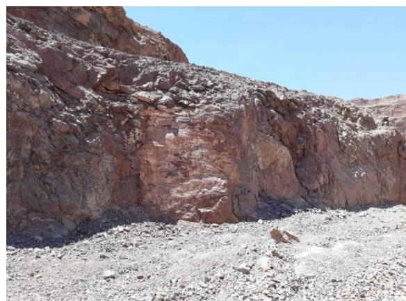
شکل ۱۰: نمایش کف پله بعد از اجرای انفجار Power Deck در معدن میشدوان
