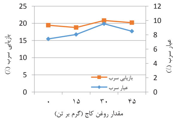
شکل ۴: تغییرات عیار و بازیابی سرب در مقادیر مختلف روغن کاج (درصد جامد: ۳۰، d_{80} : ۷۵ میکرون، ۹۰۰ گرم بر تن PAX، ۲۰۰ گرم بر تن سولفور سدیم و pH: ۹/۵)
