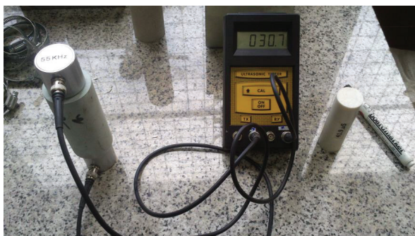
شکل ۵: نحوه قرارگیری ترانس دیوسرها روی نمونه
