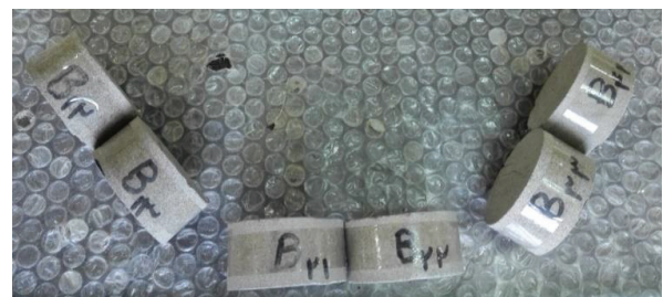
شکل ۷: نمونه‌های مناسب برای آزمایش برزلی
