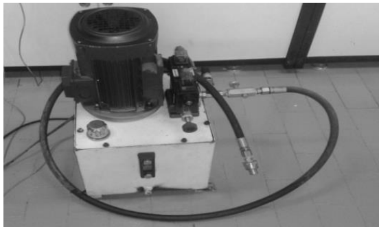
شکل ۹: پمپ اعمال کننده فشار سیال به داخل گمانه
