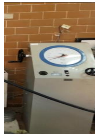
شکل ۸: پمپ اعمال فشار جانبی
