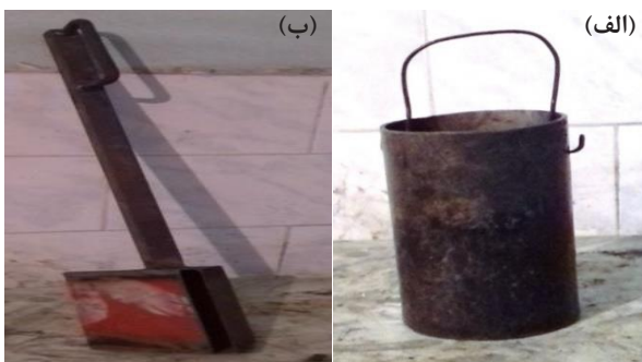
شکل ۲: نمونه گیرهای دستی، (الف) برای پالپ های با سرعت کم و (ب) ساکن، (ب) برای پالپ های جاری با سرعت بالا
