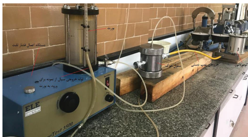
شکل ۴: دستگاه آزمایش نفوذپذیری
