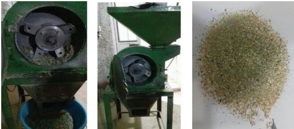
شکل ۱: خردایش اولیه نمونه و دستگاه سنگ‌شکن چکشی
