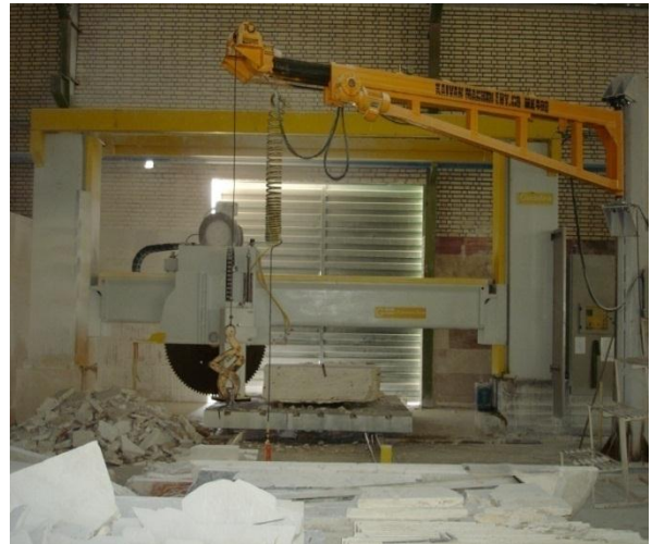
شکل ۳: تصویر سنگ لاشه‌های تولید شده در مرحله برش سنگ (یکی از واحدهای سنگبری منطقه محلات)
