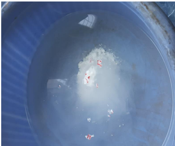
شکل ۱۲: نمونه‌ای از تراورتن B (با تحمل دمای ۸۰۰ درجه و سرد شدن در محیط آزمایشگاه، در آب به آهک مرده تبدیل می‌شود).
