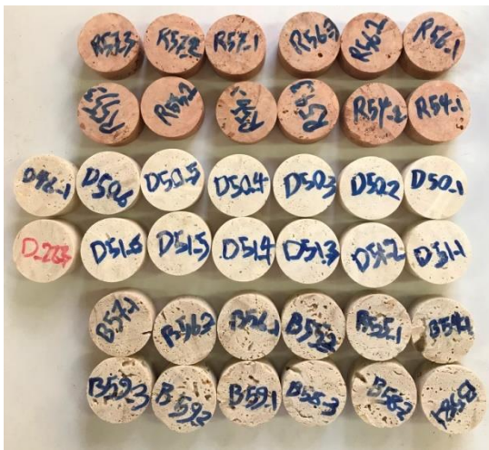
شکل ۴: تعدادی از نمونه‌های آماده شده برای آزمایش برزلی
