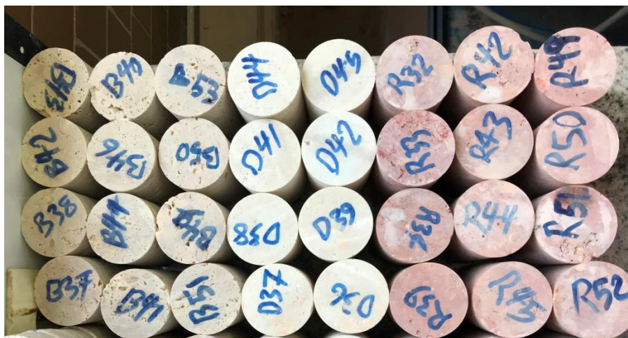
شکل ۵: تعدادی از نمونه‌های آماده‌شده برای آزمایش تراکم تک‌محوری
